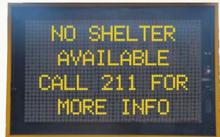
LA DOTD utiliza señales de mensaje variable (VMS) para enviar mensajes a los conductores.
